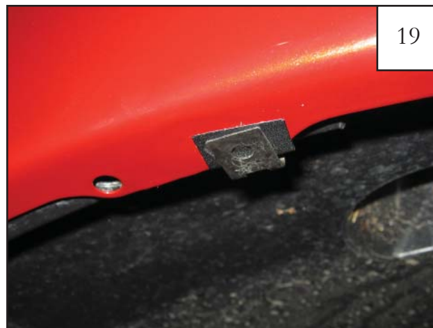
Install Clip (CL1-0022) over Tab (MT1-0014).
