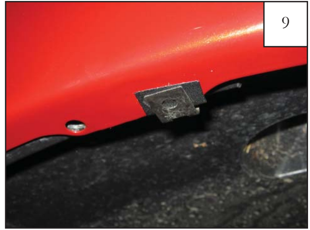
9 Install Clip (CL1-0022) over Tab (MT1-0014).
