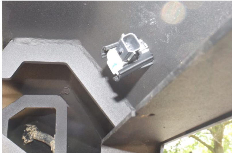
Figure 9A Inner DS Sensor Orientation
